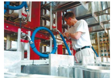
Montage eines Gleichrichters bei ABB Turgi. (Bild: ABB)
